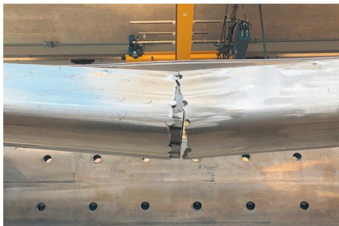
Test à la rupture d'un assemblage vissé. Photographie Morand constructions métalliques
